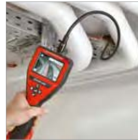
Inspección de espacios huecos
