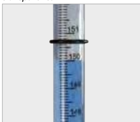
Escala de comprobación de hasta 150 mbares en tubo extensible transparente
