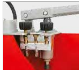
Sistema de doble válvula: permite la autocomprobación de la bomba, así como un ajuste fino y preciso de la presión
