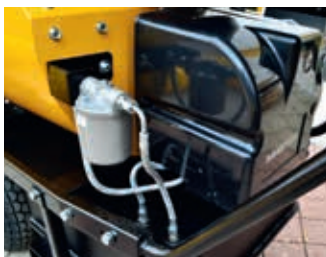
El filtro de combustible está en el exterior. El quemador está dotado de pre- calentador de combustible.
