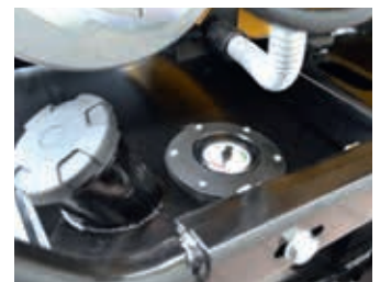
Cierre hermético y robusto del depósito y cómodo indicador de nivel de combustible.
