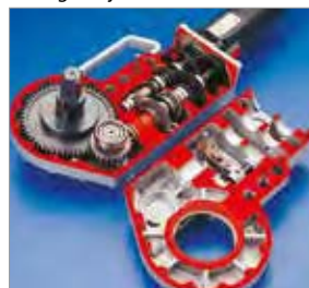
Mecanismo con siete ejes de engranajes
