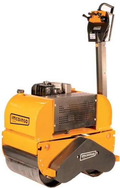
La equilibrada motorización del equipo aporta una potencia de compactación de 20 kN, con una velocidad máxima de 58 m/min y una pendiente máxima del 40%.
